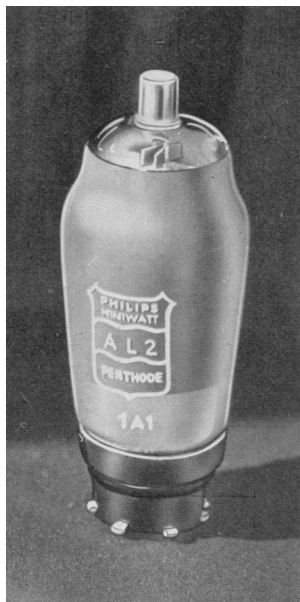
AL2, die neue indirekt geheizte Endpenthode.
